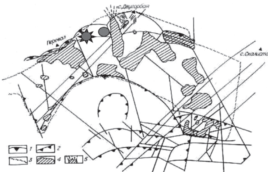
Рис. 2. Границы поля гидротермальных изменений [6]: 1 — структура зоны кальдерного обрушения и размещения в ней зон гидротермально измененных пород, внешний дуговой разлом; 2 — внутренние дуговые и линейные разломы; 3 — граница зоны гидротермальных изменений; 4 — участки наиболее интенсивной гидротермальной проработки лав; 5 — зоны развития кварц-опаловых жил. Звездочкой и кружком показаны места нахождения россыпей соответственно опалов и халцедонов
