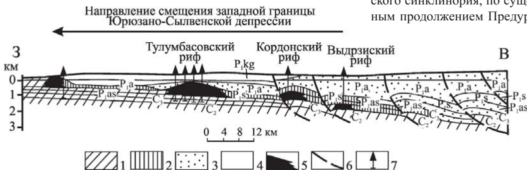
Рис. 3. Тектоно-формационный профиль Юрюзано-Сылвенской депрессии на широте г. Кунгура (Казанцев и др., 1999, с дополнениями). 1-5 – формации: 1 – платформенная, 2 – депрессионная, 3 – флиш, 4 – сульфатная, 5 – рифовая; 6 – надвиги; 7 – скважины.
