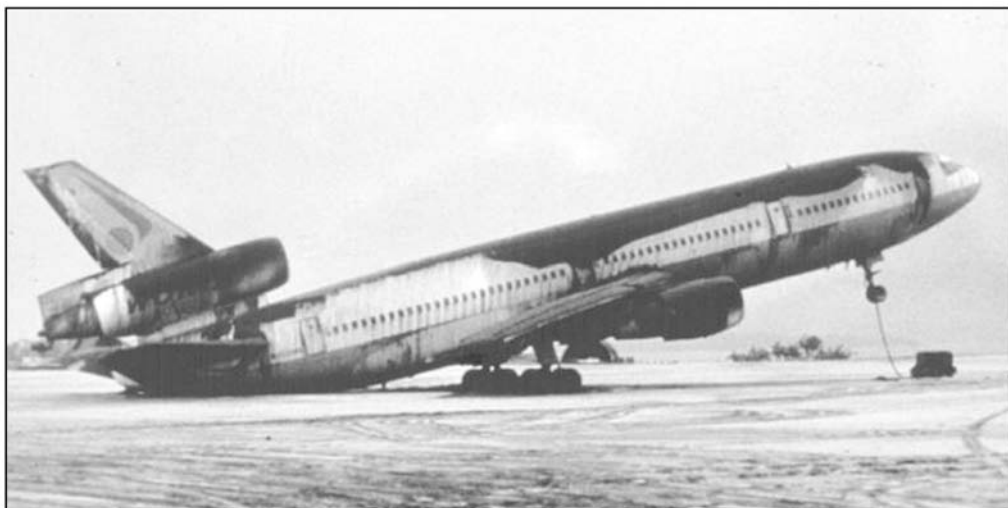
Рис. 2. Самолет DC-10 на авиабазе США в Кьюби-Поинт (Филиппины). Осаждение мокрого пепла привело к смещению центра тяжести стоящего самолета и заваливанию его на хвостовую часть
