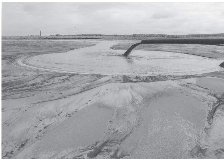
Рис. 1. Гидротранспортировка золошлаковых отходов на золоотвал. ТЭЦ-1, г. Хабаровск.
