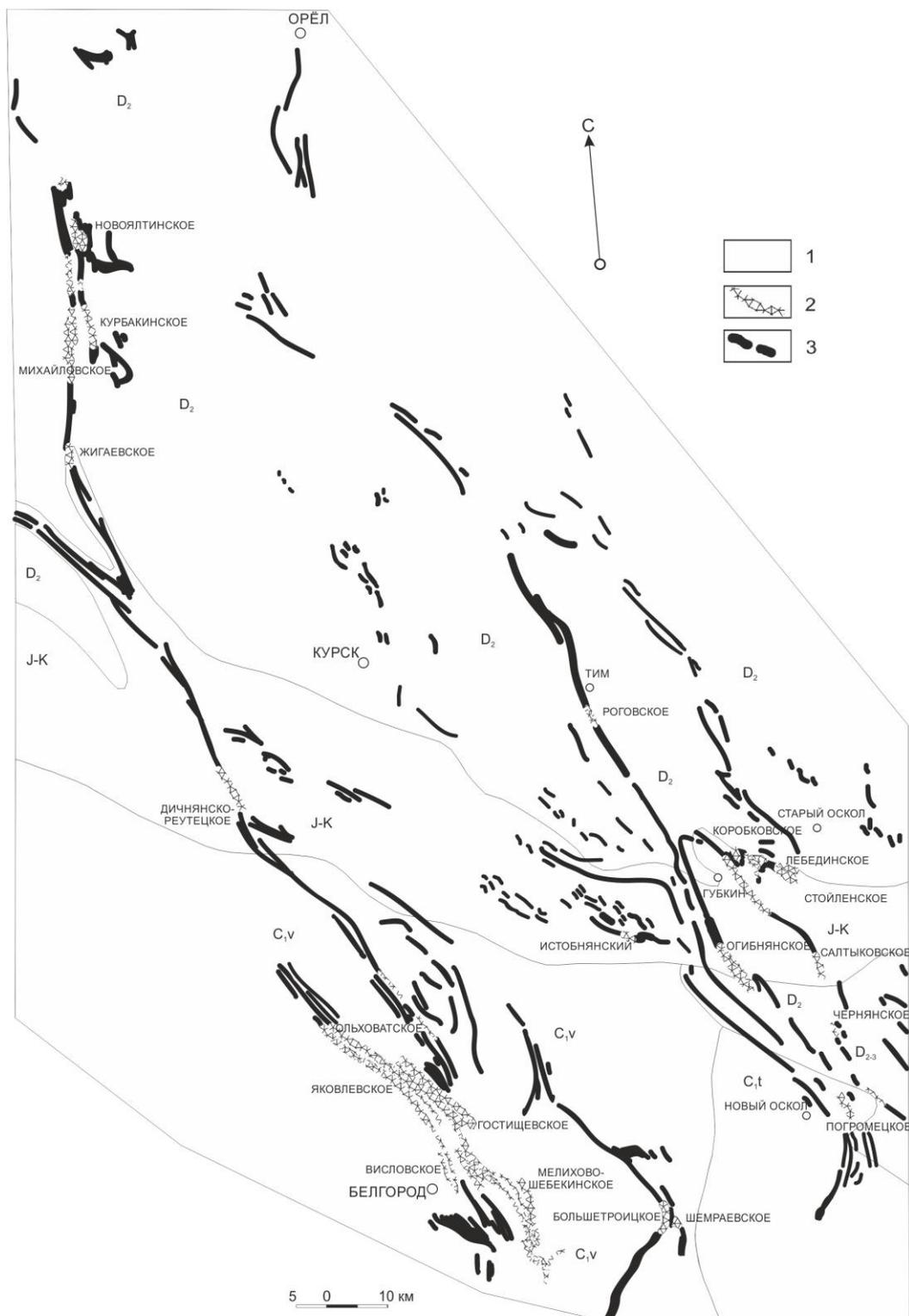
**Рис. 1.** Схема распространения железорудных кор выветривания в пределах бассейна Курской магнитной аномалии: 1 – осадочный чехол (глины (J-K); известняки и доломиты (C<sub>1v</sub>); глинистые известняки (C<sub>1t</sub>); глины и аргиллиты карбонатизированные (D<sub>2</sub>)); 2 – залежи богатых железных руд; 3 – железистые кварциты и сланцы
