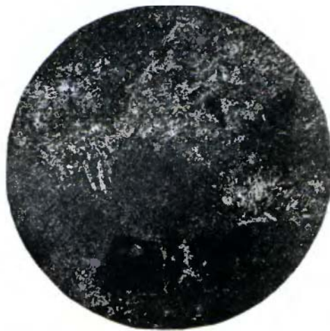
Фиг. 17. Микролиты плагиоклаза, задетые глубоким процессом алуни- зации. Увелич. 30. Николи +. Обр. № 36
