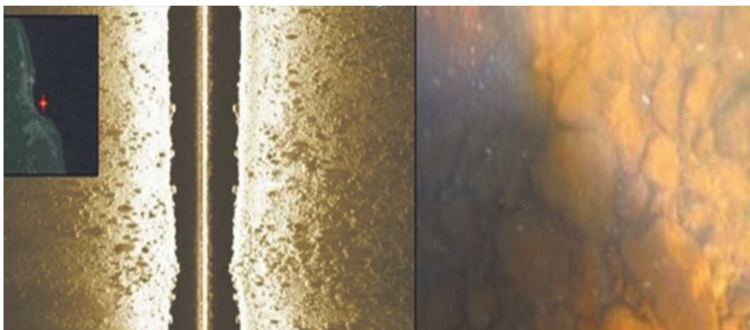
Рис. 2. Результаты подводной съемки и сонограмма для бухты Рыбрека. Слева – сонограмма, на которой прослеживаются валуны (галька в таком масштабе неразличима). Справа – фотографическое изображение дна, в частности мелких валунов и гальки
