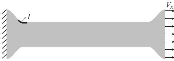
Рис. 2. Геометрическая модель нагружаемых образцов, 1 — область первоначального зарождения пластических сдвигов на свободной поверхности
