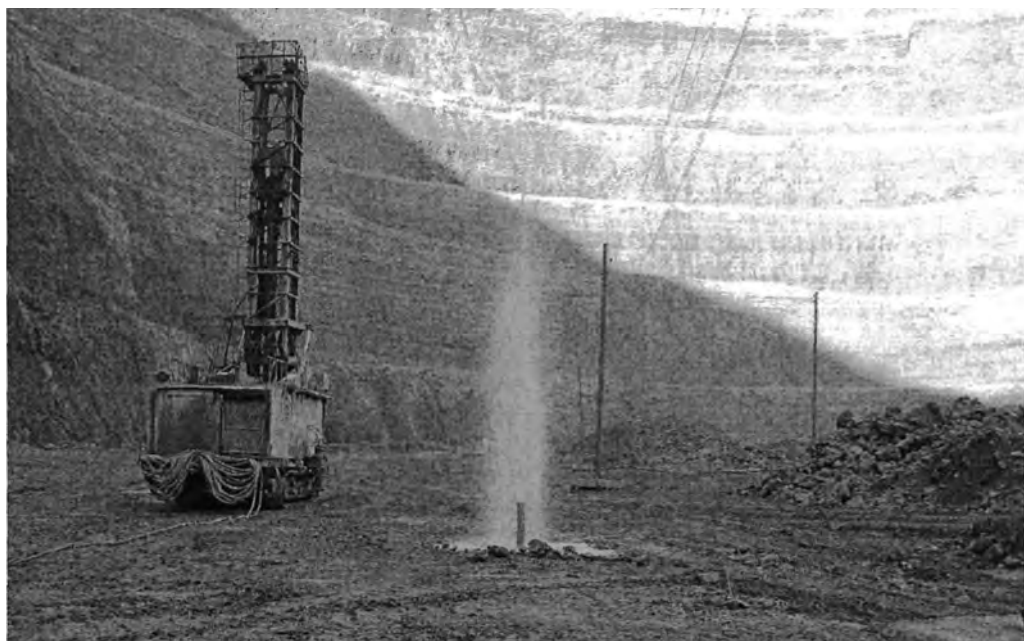
Рис. 1. Выброс газонасыщенных рассолов из приконтактной скважины на горизонте -205 м в карьере «Удачный»
