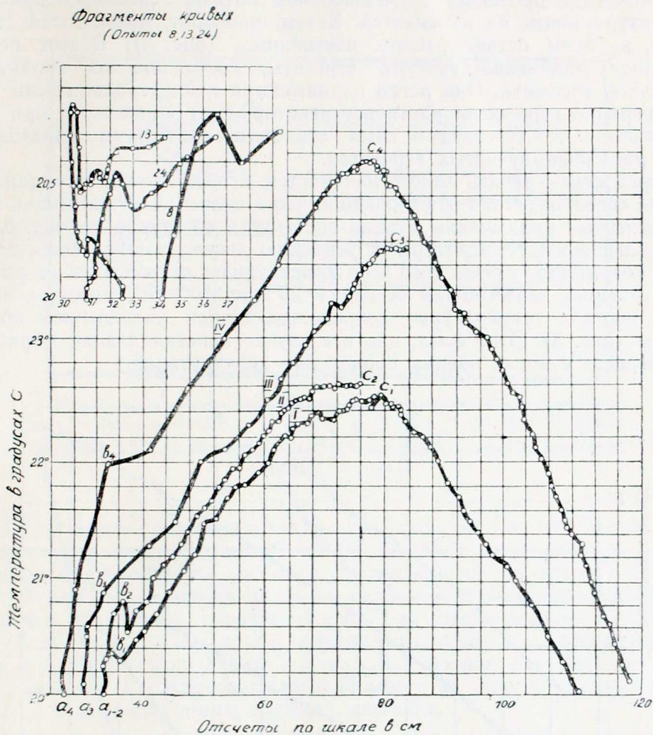
Рис. 2. График изменения объема и температуры системы при кристаллизации мирабилита (пересыщение: I—22 г, II—26 г, III—36 г, IV—40 г на 100 см 3 ; a_{1-4} — v_{1-4} — первый, v_{1-4} — c_{1-4} — второй период кристаллизации)
