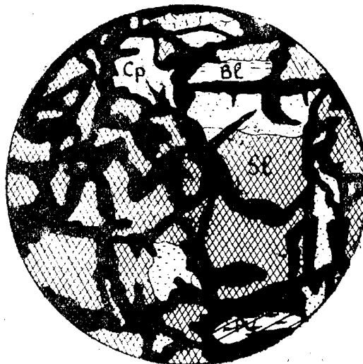
Рис. 6. Петельчатая структура замещения сфалерита (SI) халькозином (черный). Ср—халькопирит; Py—пирит; Bl—блеклая руда. Ув. 275.
