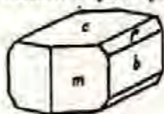
Рис. 1. Кристалл лангита из Березовского золоторудного месторождения. Простые формы: пинаконды c\{001\} и b\{010\} , а также ромбическая призма f\{021\}
