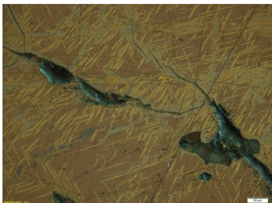
Рис. 3. Структура распада халькопирита в борните. Полированный шлиф. Увеличение 10X4
