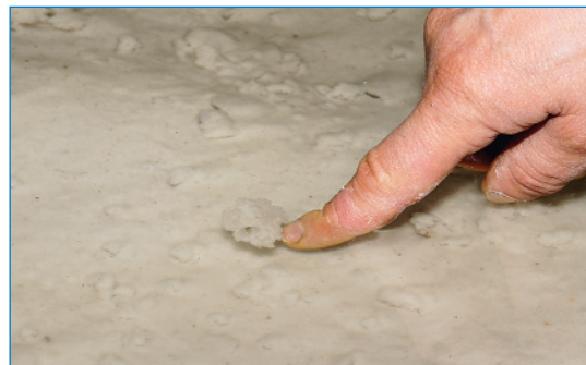
Рис. 7. Газопроявления в луже маточной рапы в теле соляной шахты (Тыретский солерудник)
