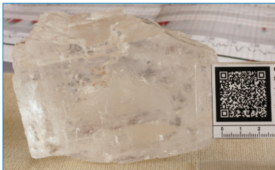
Рис. 6. Монокристалл NaCl с пузырьками газа и рапных растворов размером до 5 мм
