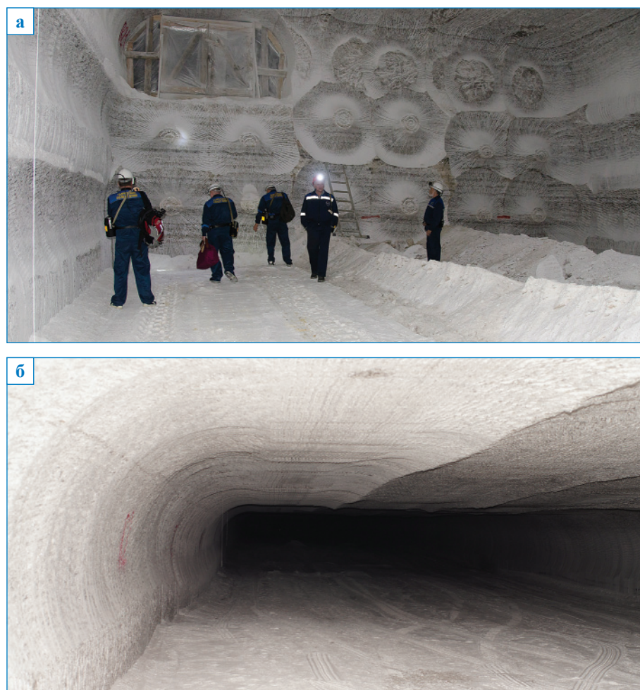
Рис. 8. Действующий забой шахты, отработанный на 70 % (а), и забой шахты, отработанный на 10 % (б) (Тыретский солерудник)
