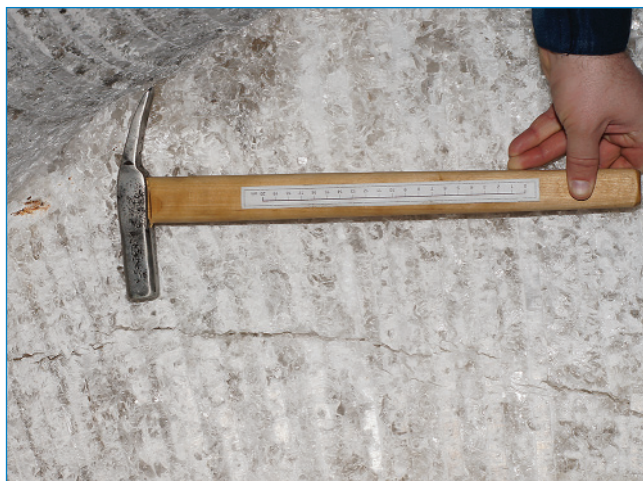
Рис. 9. Свежая трещина в стенке забоя ствола шахты (Тыретский солерудник): глубина – 600 м, длина шкалы на молотке – 20 см
