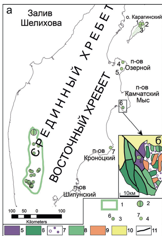
Рис. 1: а — схема расположения объектов с никелевой минерализацией на Камчатке (1–4): 1 – Камчатская никеленосная провинция, 2 – медно-никелевое месторождение Шануч; 3, 4 – проявления, пункты минерализации, их номера: 3 – медно-никелевые, 4 – медные с никелем. б – схема геологического строения южной части п-ова Камчатский Мыс (5–11): 5 – гипербазиты, 6 – габброиды, 7 – полимиктовый серпентинитовый меланж, 8 – вулканогенно-кремнистые отложения смагинской свиты, 9 – палеоценовые терригенные отложения, 10 – рыхлые плиоцен-четвертичные отложения, 11 – разрывные нарушения. Схема составлена по [1, 6, 9, 10, 11] с изменениями и дополнениями. Номера медных, никелево-медных и медно-никелевых проявлений и пунктов минерализации на схемах: 1 – Железное, 2 – Монолитное, 3 – Маркеловское, 4 – Рыцарь, 5 – Гребень, 6 – Горы Голой, 7 – Междуречье Большая-Буй
