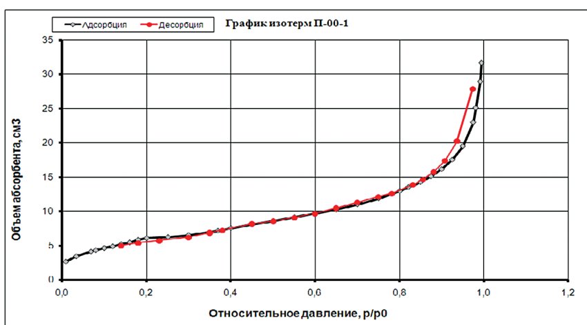
Рис. 3. Кривые сорбции - десорбции для порошка П-00-1
