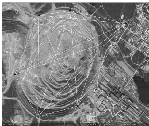
Рис. 4. Район работ и схема GNSS наблюдений
