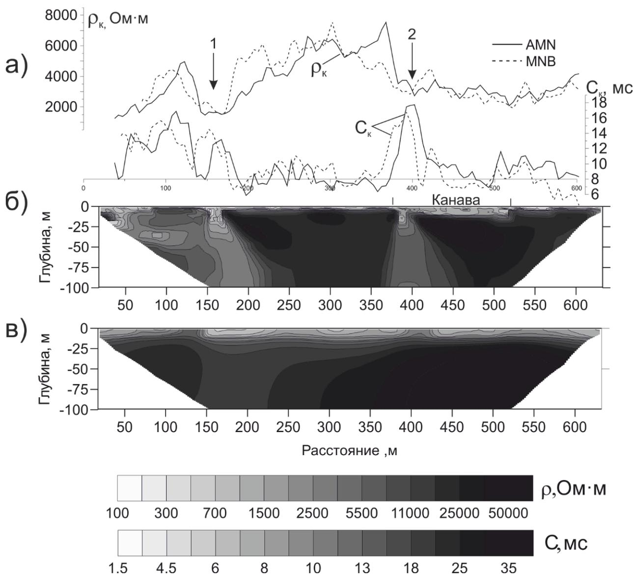
Рис. 1. Графики кажущихся УЭС ( $\rho_k$ ) и заряжаемости ( $C_k$ ) для прямой и встречной установок (а), геоэлектрический разрез (б) и разрез поляризуемости (в) по результатам 2D-инверсии данных электротомографии (прямая установка AMN)
