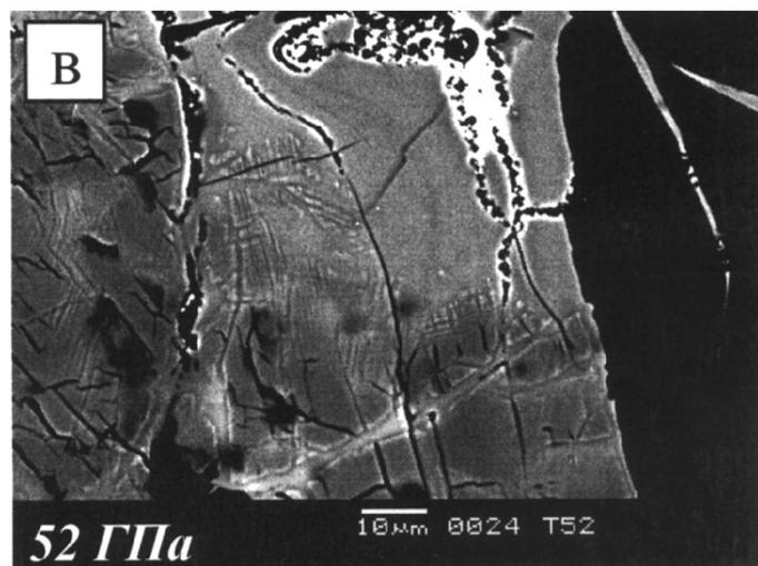
Рис. 3. Характер трещиноватости и аморфизации амфибола (а, б, в) после нагрузки 52 ГПа. Аморфизованный амфибол обладает в отраженных электронах более светлой окраской по сравнению с реликтами кристаллического амфибола, который разбит сетью многочисленных грубых трещин
