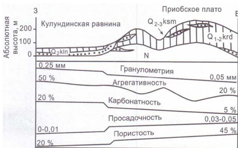
Рис. 1. Обобщенный геологический разрез четвертичных отложений Верхнего Приобья с литологической и физико-механической характеристикой
