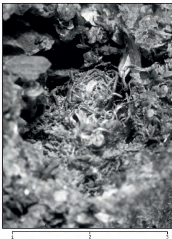
Рис. 7. Волокнистый агрегат гипогенного серебра в друзовидном кварце, вмещающем пирит-арсенопирит-пираргирит-диафорит-фрейбергит-галенитовую с серебром рудную минеральную ассоциацию. Фото А.И.Некрасова:
