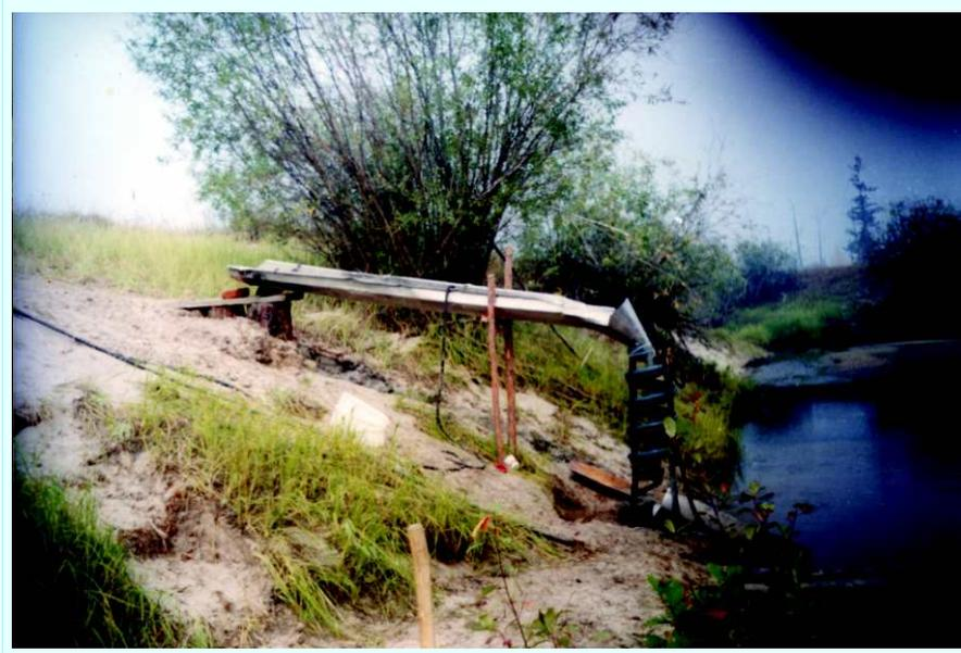
**Рис. 2. Сочетание «проходнушки» и винтового сепаратора, на котором намты пиропы.**
