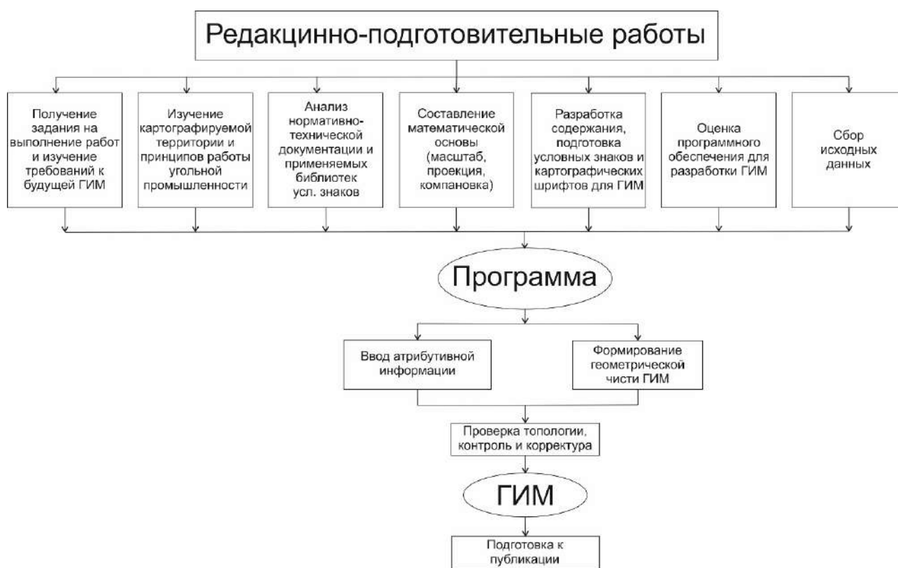
Рис. 2. Технологическая схема геоинформационного картографирования угольной промышленности
