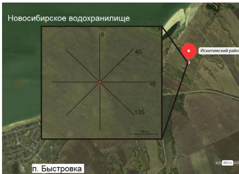
Рис. 1. Участок исследования и схема измерений методами геоэлектрики
