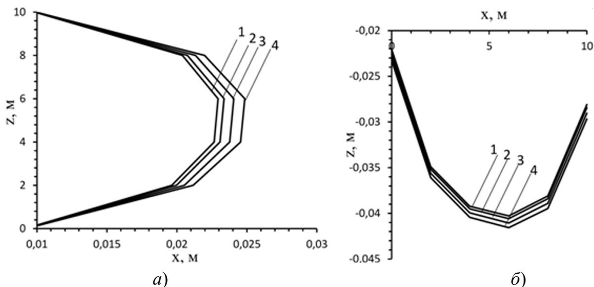
Рис. 2. Конвергенция стенок выработки (а), кровли и почвы (б) для различных значений  $t$ :
