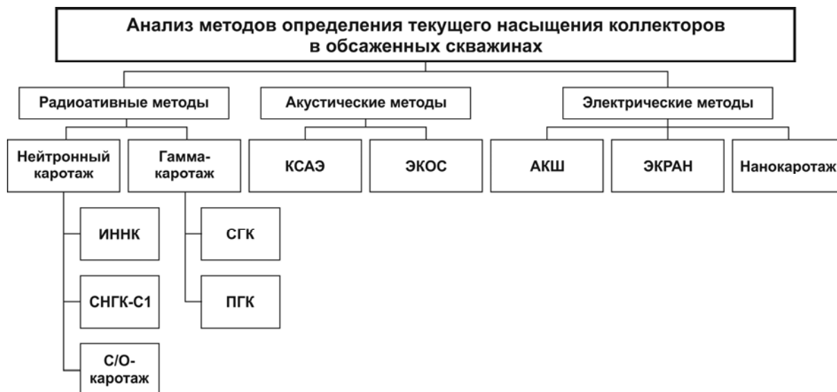
Рис. 1. Анализ методов определения текущего насыщения коллекторов в обсаженных скважинах
