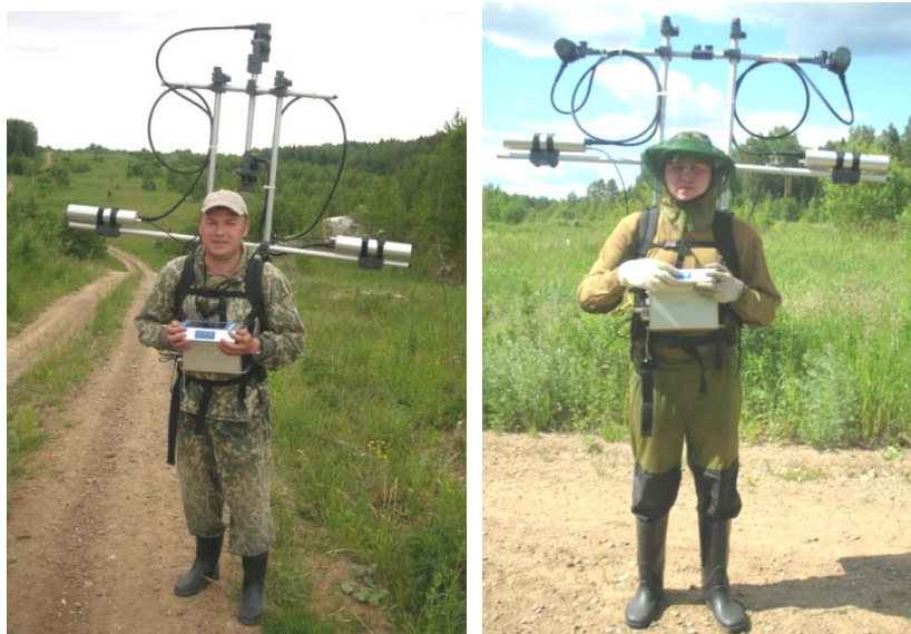
Рис. 2. Монтаж измерительных датчиков магнитометра SM-5 Navmag
