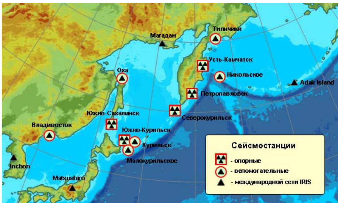
Рис. 5. Сеть станций сейсмической подсистемы Системы предупреждения о цунами по состоянию на конец 2010 года
