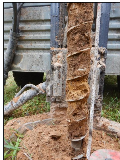
Рис. 5. Разнозернистые пески с обломками, вскрытые скважинами 08 и 14. Фото Д.В. Баранова
