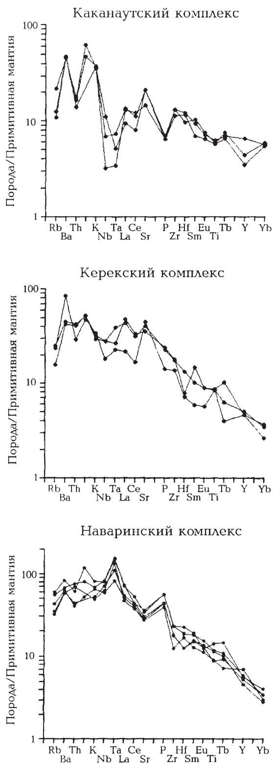
Рис. 3. Распределение некогерентных элементов в базальтах каканавутского, керекского и наваринского комплексов юго-восточной части Корякского нагорья. Породы нормированы по примитивной мантии [32].
