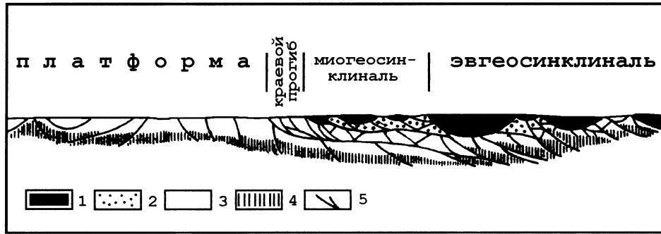
Рис. 23. Модель структуры складчатой области и ее сочленения с платформой. Составил Ю. В. Казанцев 1–3 – отложения: 1 – эвгеосинклинальные, 2 – миогеосинклинальные, 3 – платформенные; 4 – фундамент; 5 – разрывные нарушения
