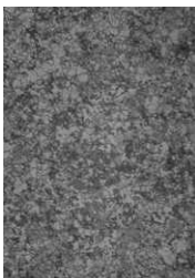
Рис. 10. Ранние везувиан-гранат-хлоритовые родингиты. Гранат отличается от везувиана более насыщенным бурым цветом. Северное рудное тело Золотой Горы. Шлиф при 1 николе. Ширина поля зрения 0.5 мм.
