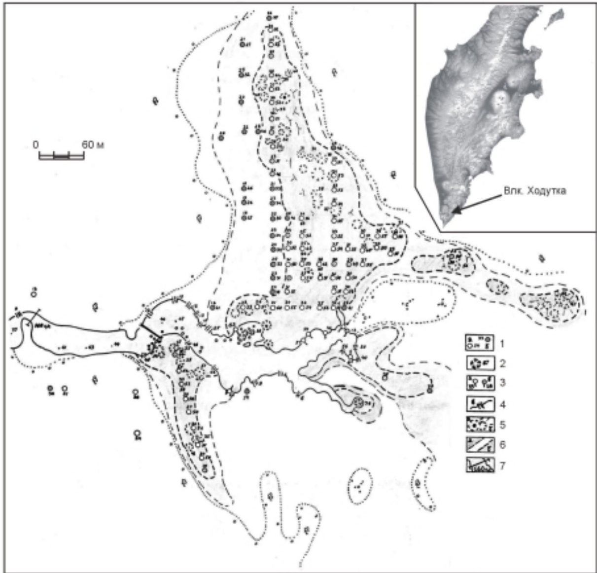
Рис. 4. Термометрическая карта очага разгрузки Ходуткинских гидротерм. 1 – точки температурного ( ^{\circ}\text{C} ) зондирования на глубине 0.5 м: а – > 50 ; б – 20-50; 2 – грифоны на дне реки; 3 – источники и их температура: а – горячие; б – холодные; 4 – линейные высачивания грунтовых вод в берегах и их температура; 5 – термальные воронки: а – с водой; б – пересохшие; б – изотермы на глубине 0.5 м: а – 20^{\circ}\text{C} ; б – 50^{\circ}\text{C} ; 7 – створ замера расхода реки, 14.08., 1996 г.
