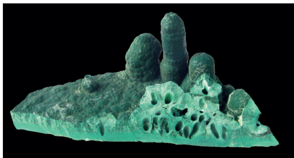
Рис. 2. Трубчатые агрегаты синтезированного малахита (пузырьковые газмиты) в кристаллической корке со дна кристаллизатора: а – закрытые трубчатые формы и одна коническая открытая, 9,5 x 4,5 см, высота самой большой 3 см; б – открытые конические трубчатые формы, образец 8,5 x 6,5 x 1,3 см. Выращено на фирме «Женави» по технологии Ленинградского государственного университета (ЛГУ, СПб). Фото: О. Look.
