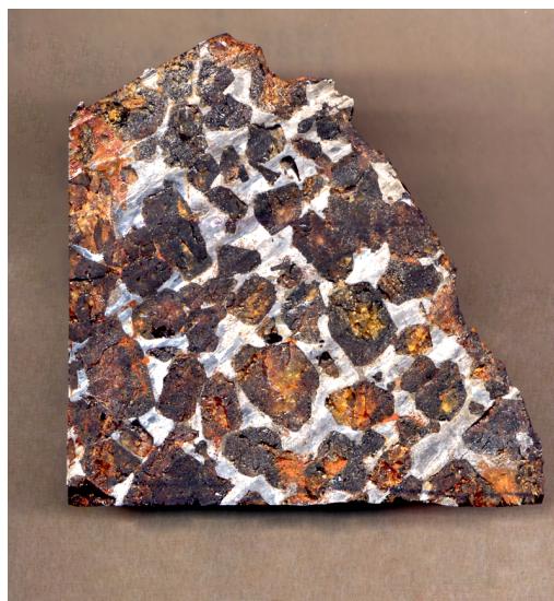
Рис. 9. Фрагмент Палласовского метеорита (палласит) — кристаллы оливина в никелистом железе (камасит + трэнит). Срез образца 8 x 8 см. Из коллекции «Русского общества любителей метеоритики». Фото: М.К. Суханов.
