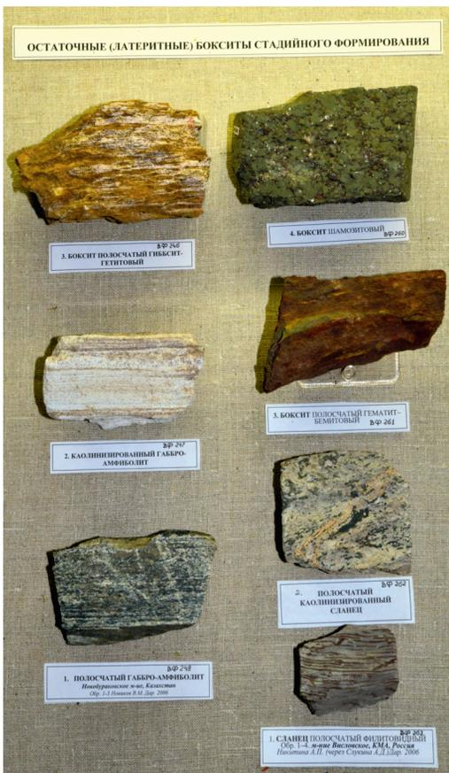
Рис. 4. Профили выветривания: слева — габбро-амфиболитов (Ново-Бураковское месторождение, Казахстан); снизу вверх: полосчатый габбро-амфиболит, каолинизированный габбро-амфиболит, полосчатый гибсцит-гетитовый боксит; справа — филлитовидных сланцев (Висловское месторождение, КМА, Россия); снизу вверх: полосчатый филлитовидный сланец, каолинизированный полосчатый сланец, полосчатый гематит-бемитовый боксит, шамозитовый боксит. Фото: М.Б. Лейбов.
