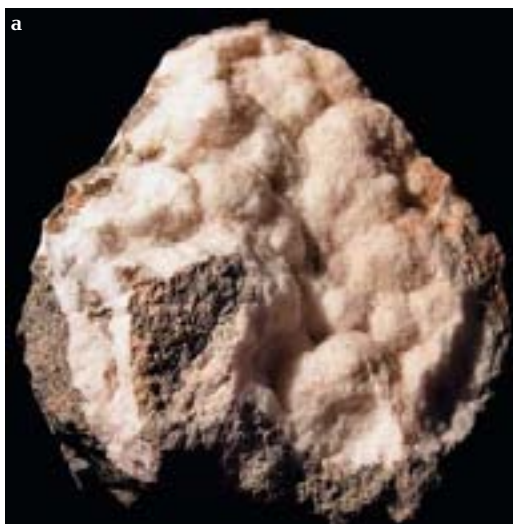
Рис. 1. Гнёзда и прожилки стронцианита в метакимберлитах: а – образец 60063, 10 см; б – образец М 28392, 9.5 см.
