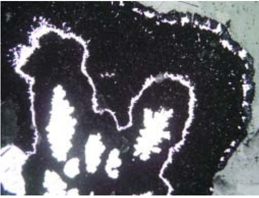
Рис. 4. Почка самородного мышьяка (черное) с прослойками лёллингита (белое). Полированный шлиф, ширина поля зрения 1 см
