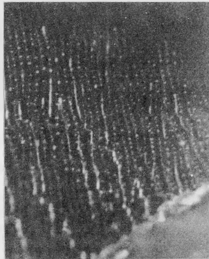
Рис. 4. Гранный рельеф деконтированной поверхности фронта кристаллизации (а) и форма пор под этим рельефом (б)
