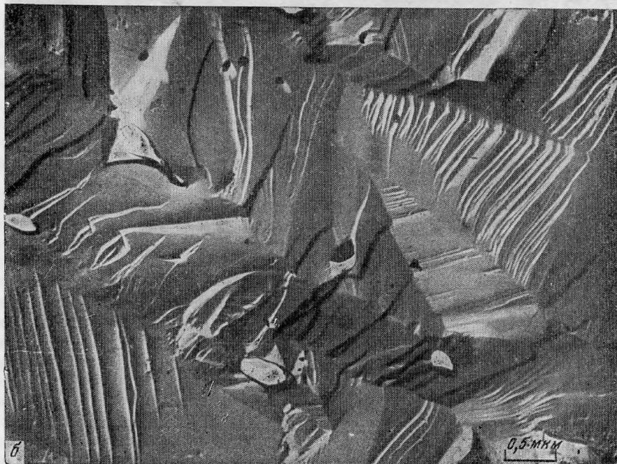
**Рис. 4. Расположение вакуолей в касситерите, выявленное под электронным микроскопом**
