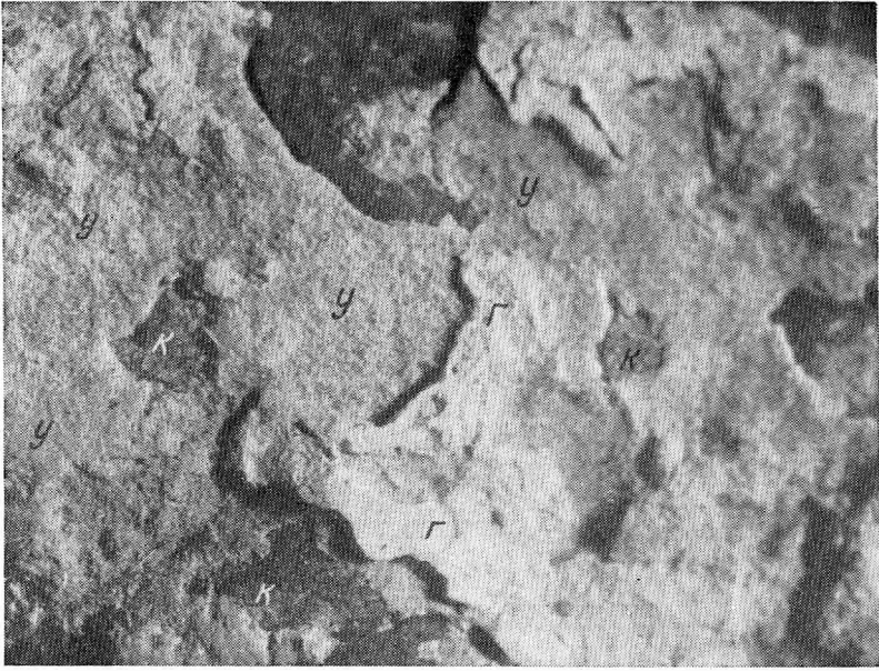
Рис. 5. Выделение кальцийурсилита (у) на кальците (к) и гипса (г) на кальцийурсилите. Natural size
