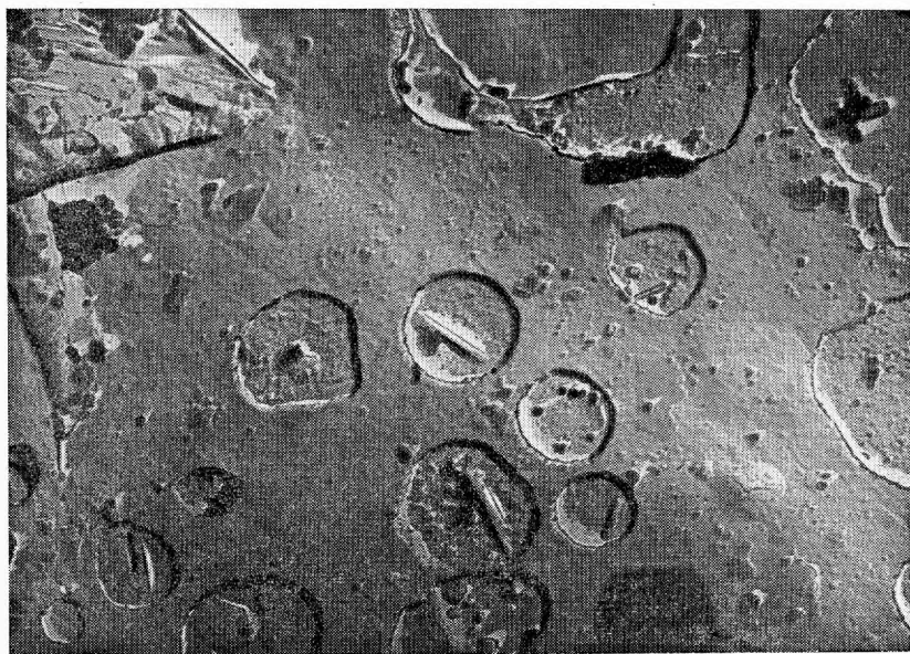
Рис. 8. Метасоматические сфероиды дисульфида железа (структуры типа «птичьего глаза») в пирротине рудных жил Джеламбета, 1196/Д-64. Снято на электронном микроскопе (угольная реплика), увел. 11 000
