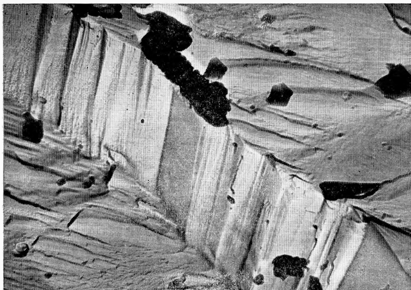
Рис. 2. Пластинчатое выделение моноклинного пирротина (светло-серое, расположенное наискось) среди матрицы гексагонального в скарнах Кузгана, Куз-1а-70. Пластина моноклинного пирротина состоит из микродоменов, ориентированных почти поперек ее удлинения. Снято на электронном микроскопе (угольная реплика), увел. 13 000
