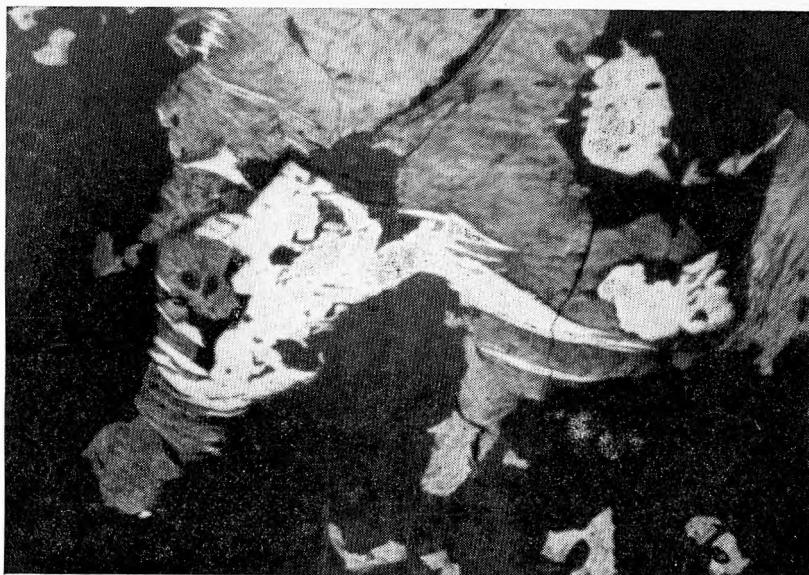
Рис. 5. Псевдоморфоза марказита (белый) по моноклинному пирротину в крупном строении гексагонального (серый) и моноклинного пирротина из рудных жил Жана-Тюбе, Ж-636-68. Полированный шлиф, покрытый магнитной суспензией, увел. 40
