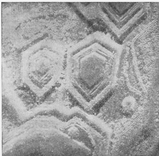
Рис. 5. Стрoение ямок травления на (0001) кварца, выявленное на электронном микроскопе
