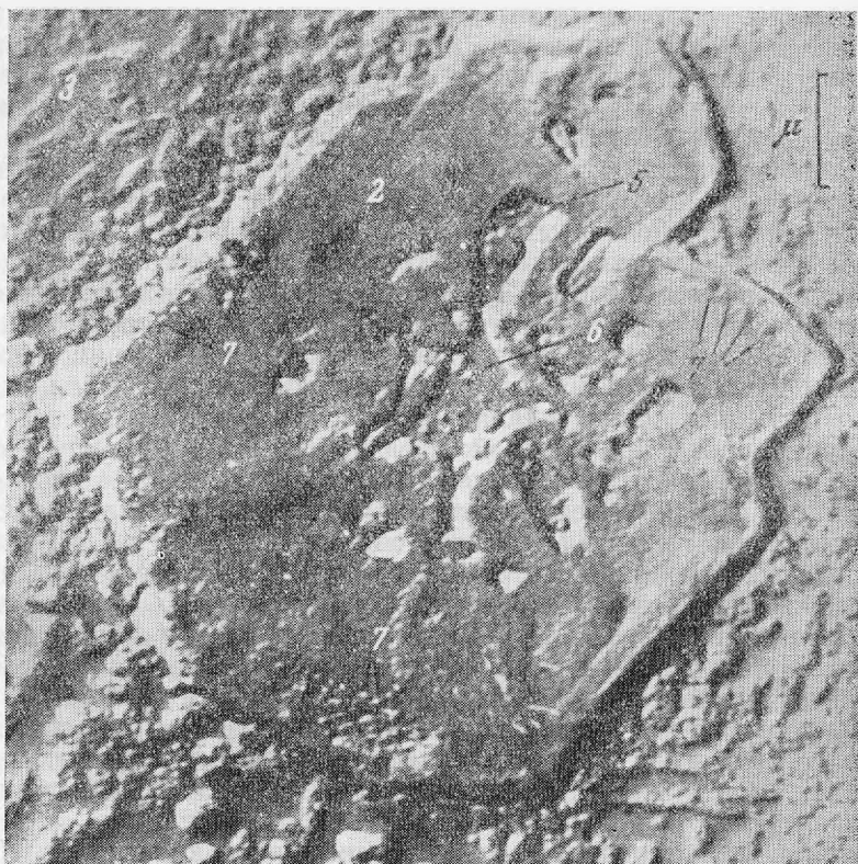
Рис. 9. Электронная фотография, иллюстрирующая характер растворения силикатным расплавом зерна кварца со стороны грани 0001
