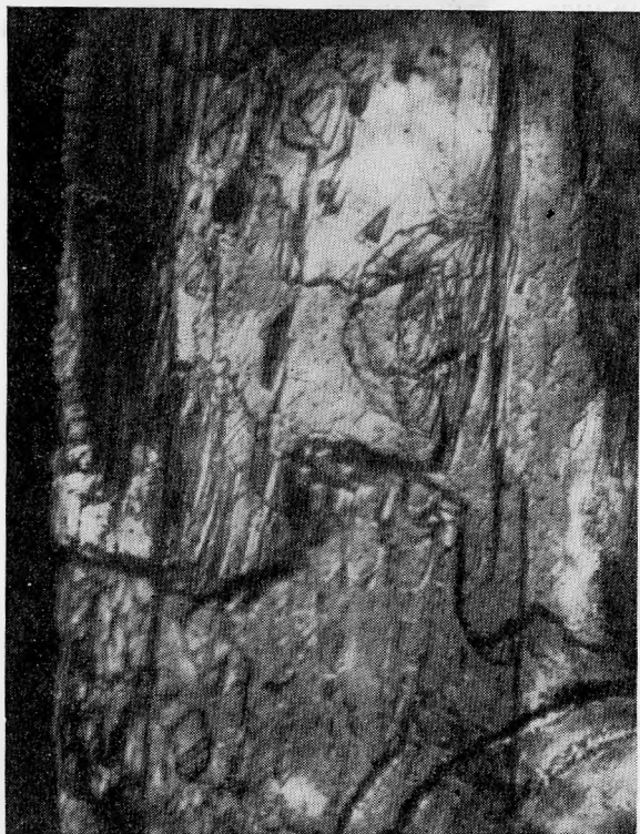
Рис. 7. Треугольные и трапециевидные фигуры растворения на грани (110) кунцита из кварц-лепидолитовой ассоциации. Увел. 50
