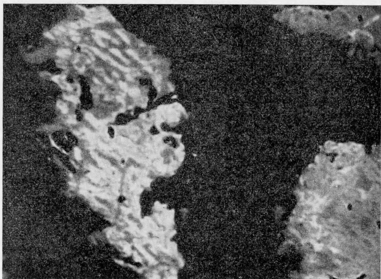
Рис. 3. Ильменит-магнетитовые обособления в участке зерна титаномагнетита. Магнетит — белые извилистые выделения. Полированный шлиф, увел. 1500, без анализатора
