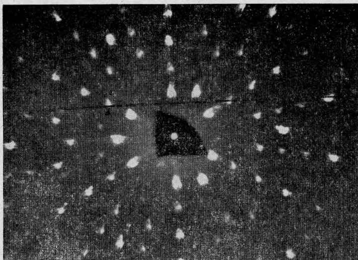
Рис. 3. Лауэграмма лепидолита; рентгеновский луч перпендикулярен спайности
