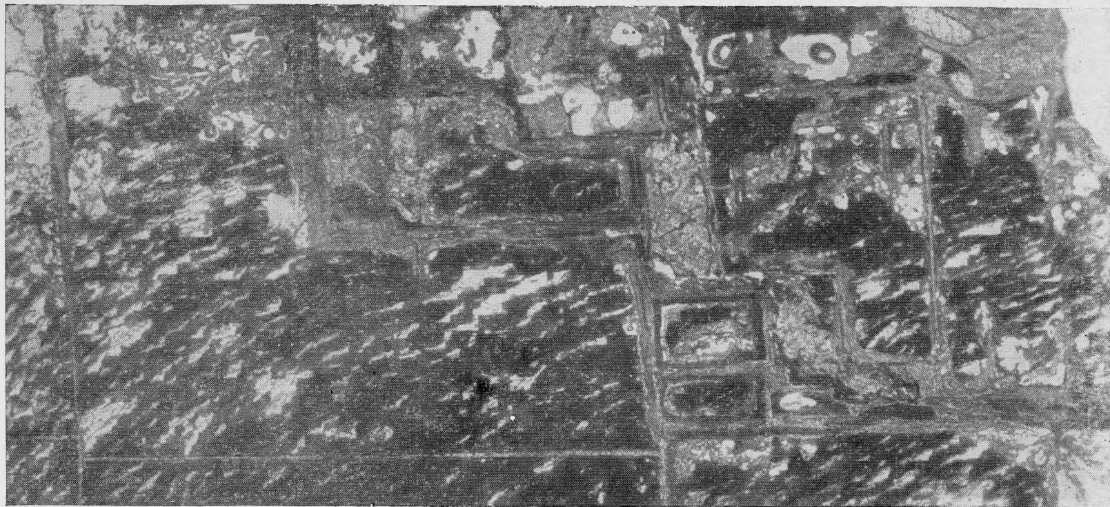
Рис. 3. Замещение галенита (черное) церусситом в направлении спайности с образованием ячеистого каркаса, выполненного колломорфными образованиями того же церуссита. В церуссите сохраняются реликты галенита. В галените видны выколки в направлении (111). Прозрачно-полированный шлиф, проходящий свет. Увел. 20
