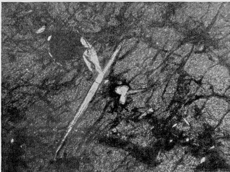
Рис. 5. Игольчатые кристаллы жедрита (светлое) в фаялите (темно-серое) около кристалла магнетита (черное). Ув. 30, при одном никеле
