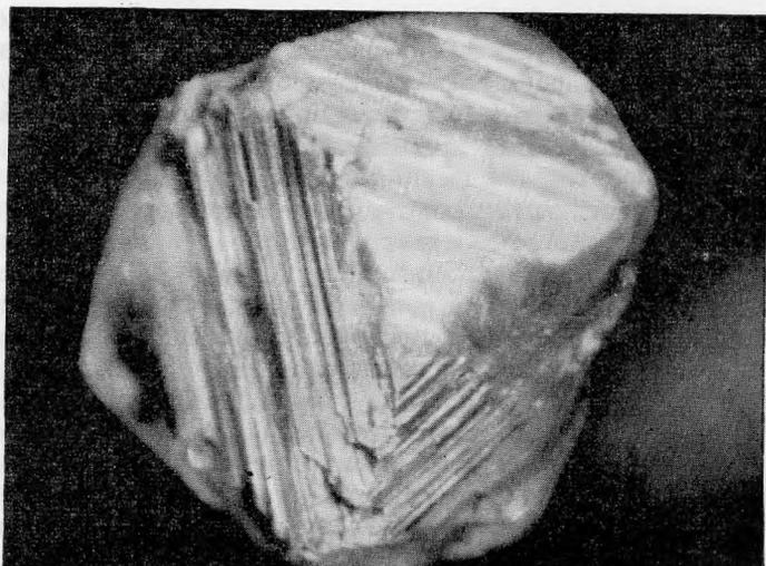
Рис. 12. Октаэдрический пластинчатый кристалл алмаза, растворенный с одной стороны вершины оси четвертого порядка. Округлая вторичная поверхность наследует все особенности исходной формы роста
