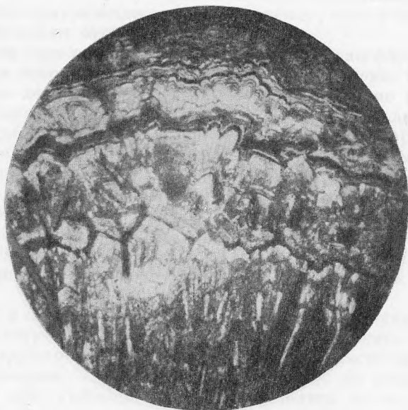
Рис. 6. Зонально-концентрический раммельсбергит-сафлоритовый агрегат. Протравлено концентрированной \text{NH}_4\text{OH} , ток 4 вольта, 30 сек. Без анализатора. \times 27
