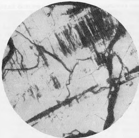
Рис. 11. Шестоватая структура отдельных зон шмальтина (белое), выявленная при замещении его вторичными продуктами (черное). Без анализатора. \times 30
