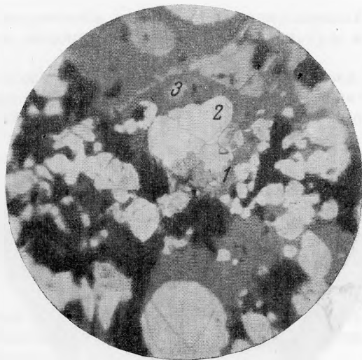
Рис. 5. Сульванит (1) корродирует зерно пирита (2), заключенное в борнит (3). Увел. 353
