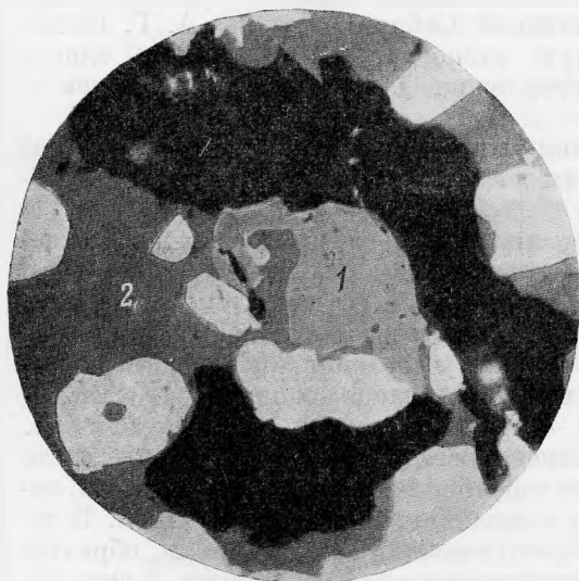
Рис. 4. Сульфит (1) в сростании с борнитом (2) и кварцем (черное). Иммерсия, увел. 450
