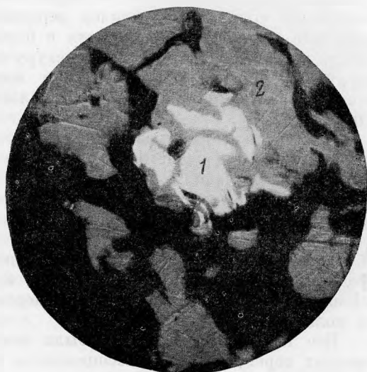
Рис. 3. Интенсивная коррозия сульфита (1) борнитом (2). Черное — кварц. Иммерсия, увел. 450
