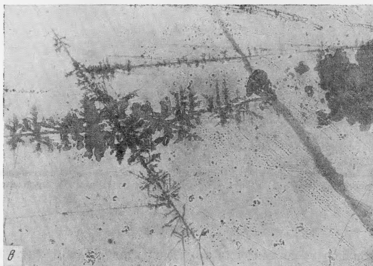
Рис. 9. Дендриты в мусковите. Проходящий свет, николи \parallel , увел. 30 a и б — видна смена сложности рисунка дендрита в зависимости от состава (окраски); в — закономерная ориентировка дендритов (по сетке ромба)
