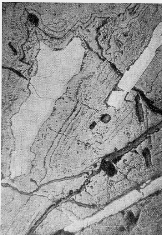
Рис. 9. Неправильные и пластинчатые выделения пирита (белое) в пустотках, выполненных магнетитом зонального строения. Мелкий прожилок пирита сетчат магнетит. Аншлиф, \times 46
