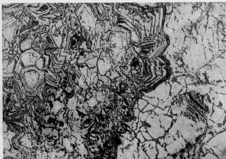
Рис. 1. Кристаллически-зональное строение магнетитовых зерен среди незональных разностей. Полированный шлиф, \times 44
